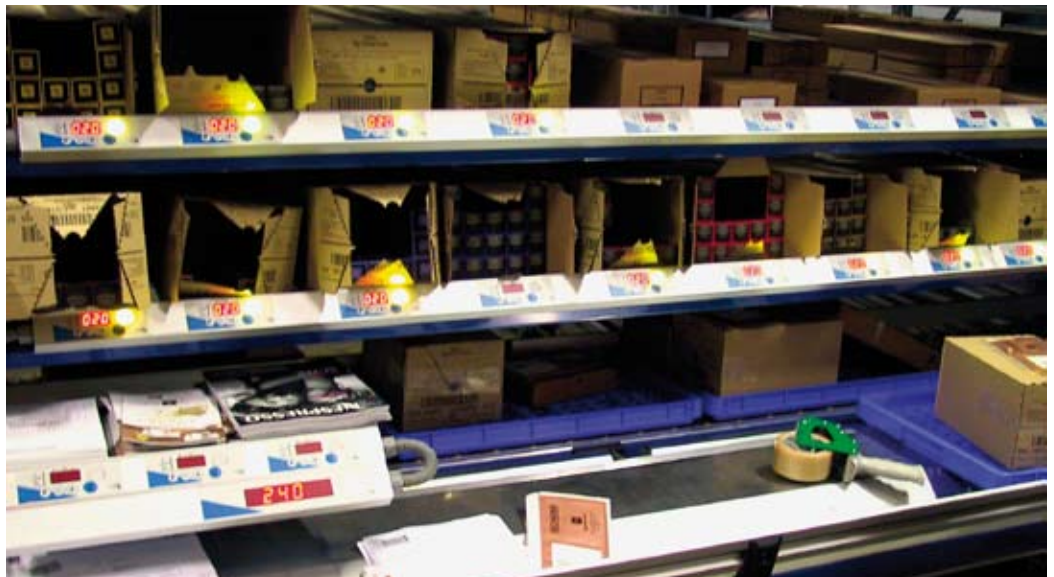
Arbeitsplatzdetailansicht mit Summenanzeige und Entnahmeplatzanzeige
