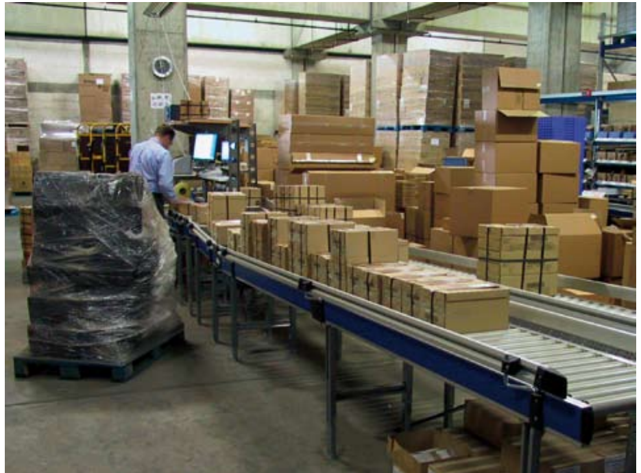
PC-Versandabfertigungsplatz mit Kontrollverriegelung und Etikettierung
